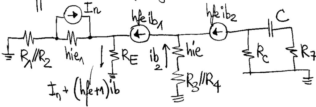
$$(R_1 // R_2)(I_n + i_{b1}) + h_{ie1} i_{b1} + R_E [I_n + (h_{fe} + 1) i_{b1}] = 0$$
