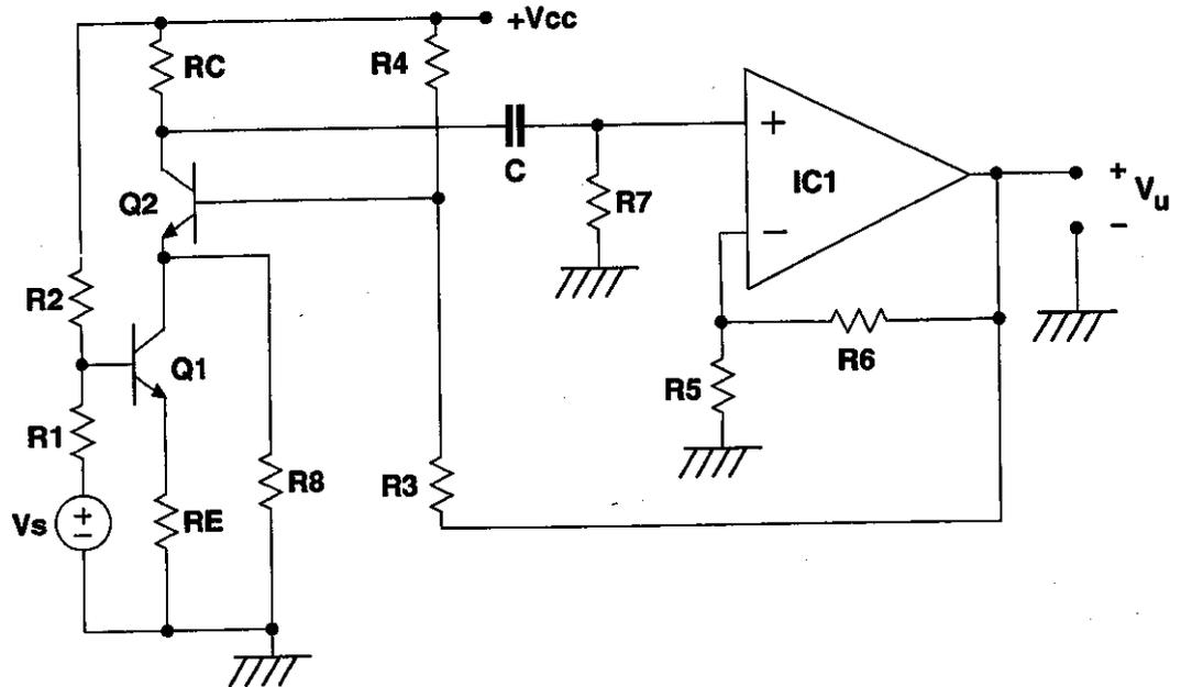
$IC_1$  è un  $\mu A$  741, con  $A_{vol10} = 250 \times 10^3$ ,  $f_p = 4 \text{ Hz}$ ,  $Z_{in} \rightarrow \infty$ ,  $Z_{out} = 0$ , alimentato a  $+V_{CC} = +15 \text{ V}$  e  $-V_{CC} = -15 \text{ V}$ ;  $Q_1$  e  $Q_2$  sono BC109B resistivi, con  $h_{oe} = 0$ ,  $h_{re} = 0$ .
