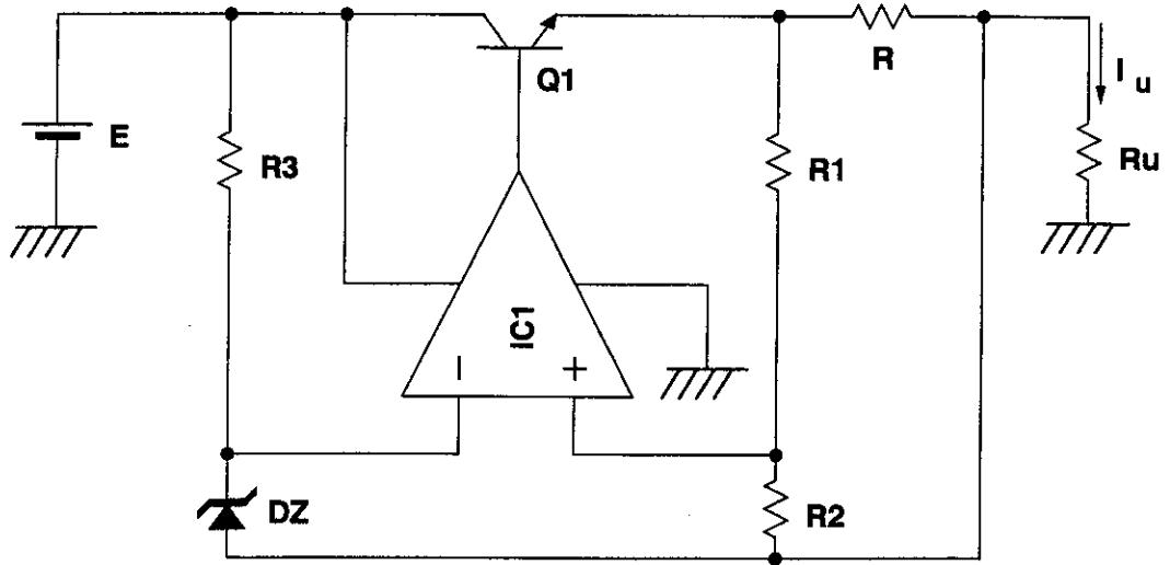
$IC_1$  è un  $\mu\text{A}$  741, con  $A_{vol0} = 250 \times 10^3$ ,  $f_p = 4 \text{ Hz}$ ,  $Z_{in} \rightarrow \infty$ ,  $Z_{out} = 0$ ,  $E = 24 \text{ V}$ ,  $D_Z$  è un diodo Zener con  $V_Z = 3.6 \text{ V}$  e resistenza differenziale nulla,  $Q_1$  è un BC109B di cui si puo' trascurare  $C_{b'c}$ .
