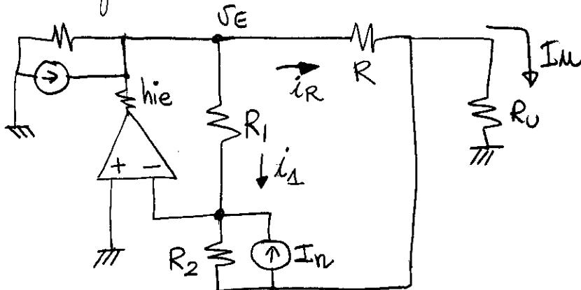
$V_{in} = 0$  per il C.C.V.
