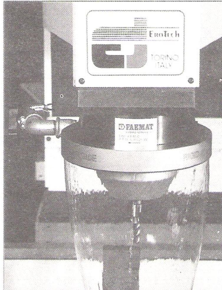
*Figura 4.3 - Fresatura programmata, ad alta velocità, di un elettrodo in grafite, con macchina EroTech ECM 500. La lavorazione è eseguita dentro una campana a velo d'acqua per l'abbattimento totale delle polveri. (EROTECH s.r.l. - Torino)*
