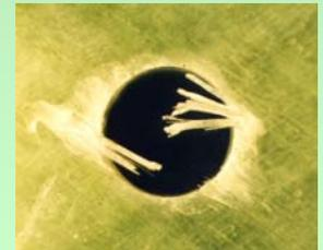
Esempio di delaminazione in uscita
