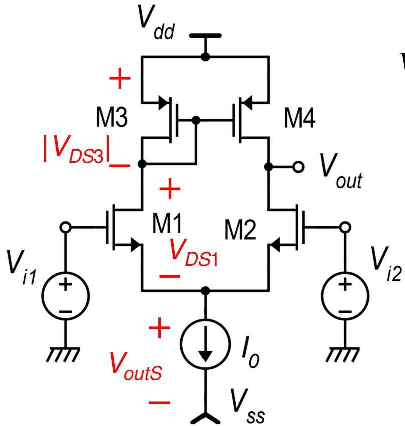
$$V_{dd} - V_{ss} = V_{outS} + V_{DS1} + |V_{DS3}|$$
