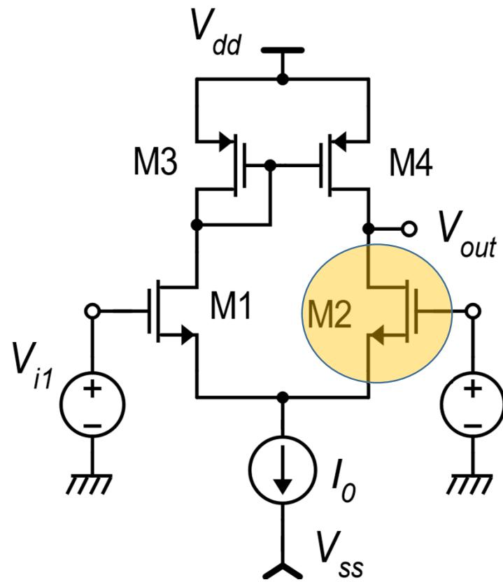
$$V_{DS2} \geq V_{DSAT2}$$
