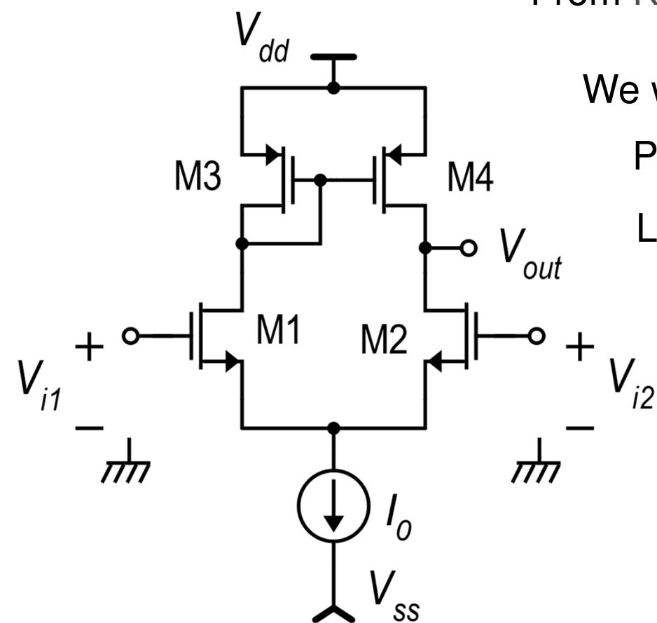
From Kirchhoff #2:  $V_{DS1} + |V_{DS3}| = V_{DS2} + |V_{DS4}|$
