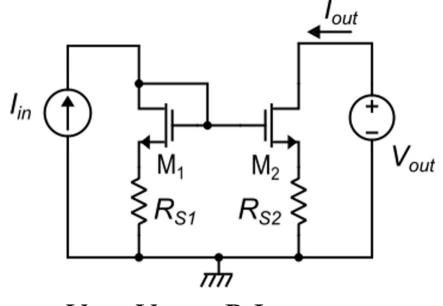
$$V_{in} = V_{GS1} + R_1 I_{in}$$
