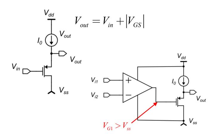
$$V_{out} > V_{ss} + \left| V_{GS} \right|$$
