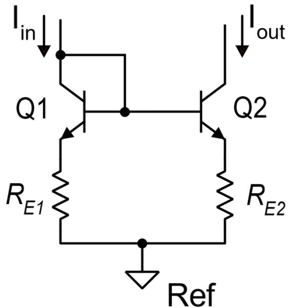
$$V_{IN} = V_{BE1} + R_{E1}I_{E1}$$
