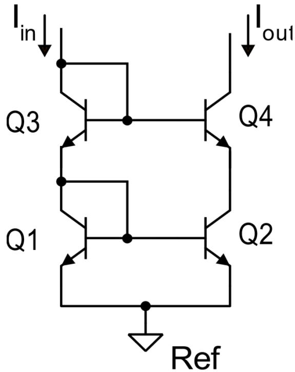
$$V_{IN} = V_{BE1} + V_{BE3} \approx 2V_\gamma$$
