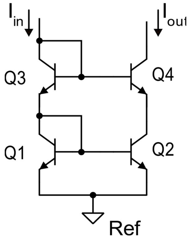
$$V_{CE2} = V_{CE1} + V_{BE3} - V_{BE4}$$
