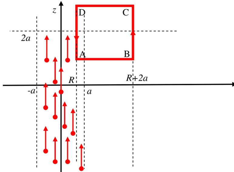
La somma delle forze è zero se  $R = a(\sqrt{2} - 1)$ . La somma delle forze è ancora zero se si ruota la spira di 180 gradi, scambiando i lati BC e AD.
