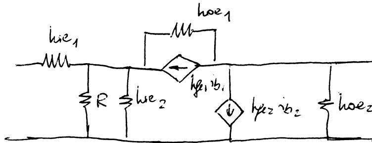
con l'uscita cortocircuitata la resistenza  $1/h_{ie1}$  si trova in parallelo ad  $R$  ed  $h_{ie2}$ .
