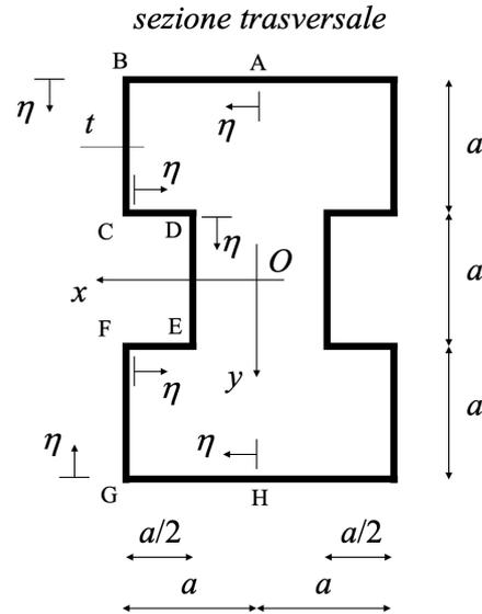
Una trave avente la sezione trasversale mostrata nella figura a destra ( $t/a = 1/10$ ), di lunghezza  $l = 10a$ , è incastrata alle estremità ed è soggetta a un carico uniformemente distribuito d'intensità  $p$ .
