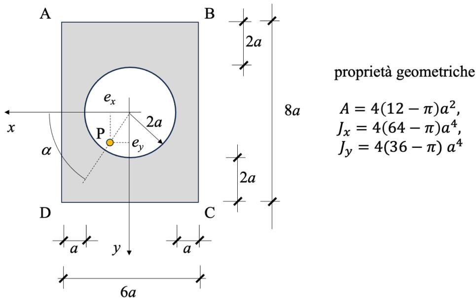
La sezione trasversale mostrata nella figura è soggetta a uno sforzo normale eccentrico d'intensità fissata,  $F$  ( $F > 0$ ). L'eccentricità della retta d'azione dello sforzo normale è individuata dal punto P di coordinate  $(e_x, e_y)$ , che si assume interno al cerchio di centro l'origine e raggio  $2a$ :
