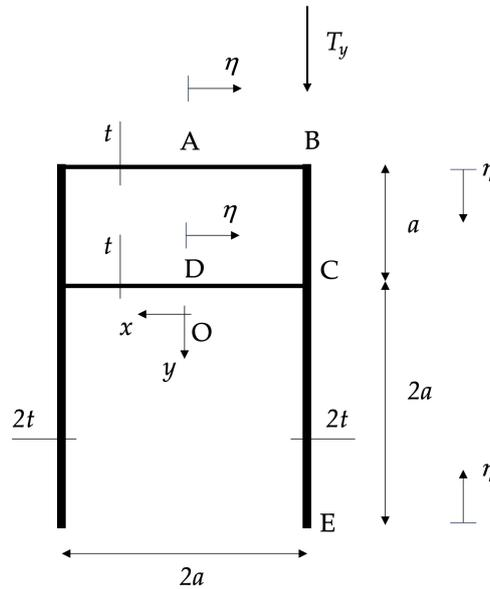
La sezione trasversale mostrata in figura ( $t/a = 1/20$ ;  $OD = a/4$ ,  $J_x = 13ta^3$ ) è soggetta all'azione di uno sforzo di taglio  $T_y$  diretto parallelamente all'asse  $y$  e passante per B.
