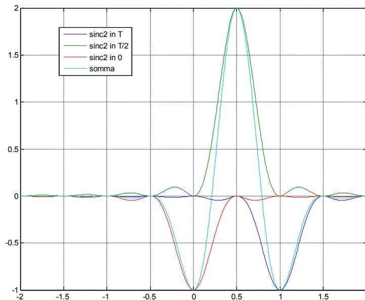
4) Il sistema introduce distorsioni di ampiezza, poiché nella banda del segnale  $H(f)$  non ha un modulo costante. Non introduce distorsioni di fase perché la fase è lineare.
