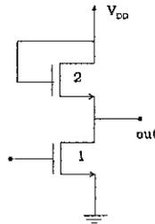
2) Il terminale out è schematizzabile con una capacità verso massa. Disegnare il circuito equivalente DC quando  $V_{GS1} < V_{TH}$ .
