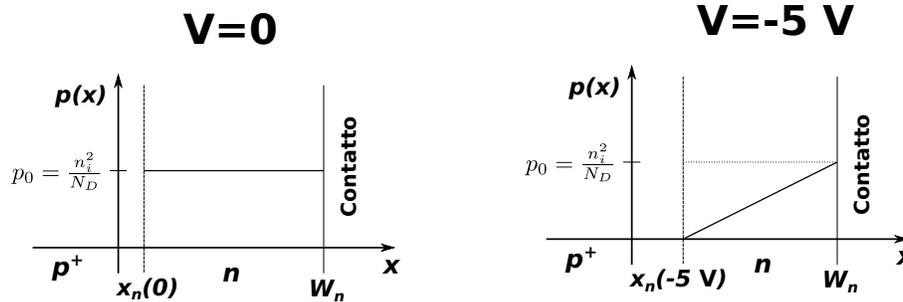
Essenzialmente per  $V = 0$  la concentrazione  $p(x)$  è 0 nella regione di svuotamento (approssimazione di svuotamento completo), è costante al di fuori della regione di svuotamento e pari a  $p_0 = \frac{n_i^2}{N_D}$ . Per  $V = -5 \text{ V}$  la regione di svuotamento si allarga, e all'estremo  $p(x_n) = 0$ . La concentrazione  $p(x)$  cresce linearmente fino a  $p_0$  sul contatto, per  $x = W_n$ .
