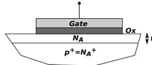
1) Disegnare qualitativamente l'andamento del campo elettrico all'inversione, in funzione di  $x$ , e scriverne un'espressione analitica in funzione di  $\mathcal{E}(x = t)$  per  $0 < x < t$  ( $x = 0$  all'interfaccia ossido-silicio). Per inversione si intende  $n_s = N_A$  (non  $N_A^+$ ).[4]
