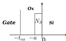
1) Per  $V_{GBulk} = V_{TH}$  calcolare: 1) il campo elettrico all'interfaccia ossido-silicio, per  $x = 0^-$  e  $x = 0^+$ ; 2) il campo elettrico in  $x = -a = -t_{ox}/3$ ; 3) il campo elettrico in prossimità del Gate (per  $x = -t_{ox}$ ). [3]
