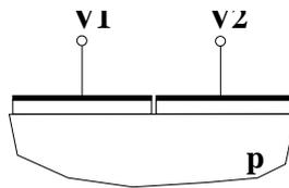
1) Per  $t = 0$  la tensione  $V_1$  viene portata bruscamente a  $+5 \text{ V}$ . Determinare la carica fissa e mobile, e la profondità della regione di svuotamento, per  $t = 0^+$ , per entrambi i condensatori (ATTENZIONE trascurare la regione di svuotamento in accumulazione). [4]
