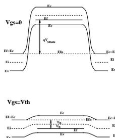
ossido-silicio è pari a  $V_{SBulk}$ . Per  $V_{GS} = V_{GSinv} = V_{TH}$  la differenza di potenziale tra pozzetti e interfaccia ossido-silicio è pari a  $2\psi_B$ . Il quasi-livello di
