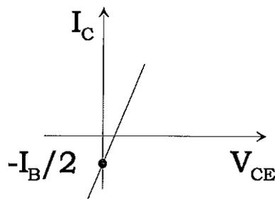
3) La corrente di base è nulla; la giunzione CB è polarizzata inversamente, quella BE direttamente.
