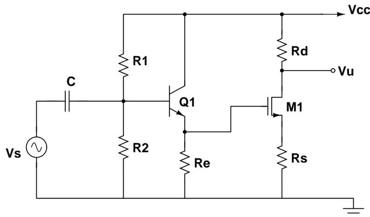
punto di riposo dei transistori e la tensione in uscita a bassa frequenza.
