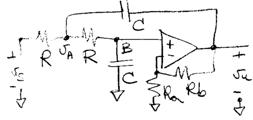
equal mode A:  $\nabla_A \left[ \frac{2}{R} + CS \right] - \frac{\nabla_S}{R} - \frac{\nabla_R}{A_V R} - \frac{\nabla_R}{A_V R} = 0$
