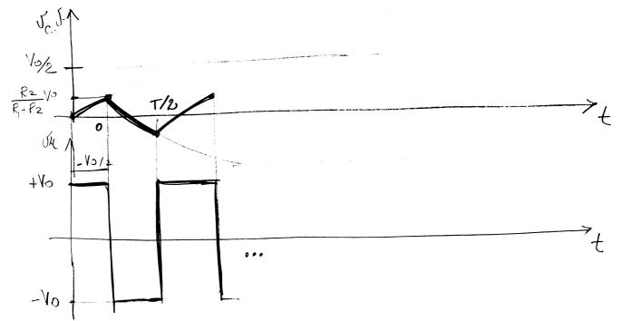
La forma d'onda è simmetrica. Calcoliamo il semiporiodo. T/2. Espressione della tensione sulla cepecità:
