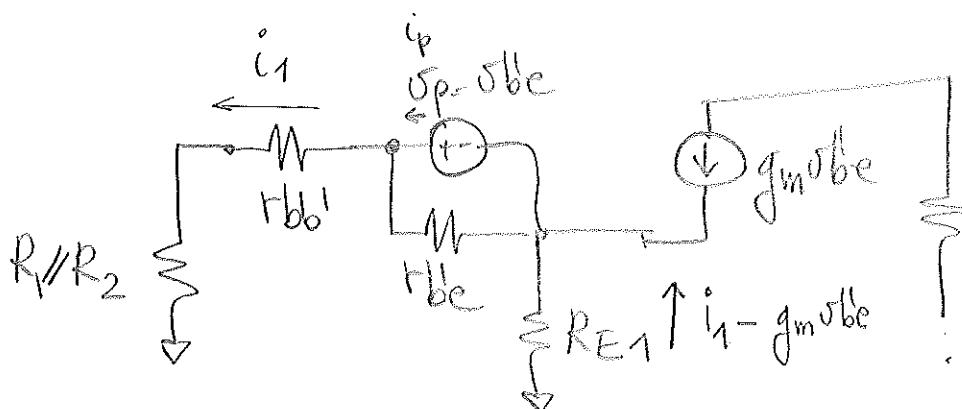
$$V_p = (R_{bb'} + R_1 // R_2) i_1 + R_{E1} (i_1 - g_m V_p)$$
