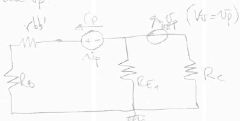
$$V_p = (r_{bb'} + R_B) \frac{i_p}{i_p + R_{E1}} (i_p - g_m V_p)$$
