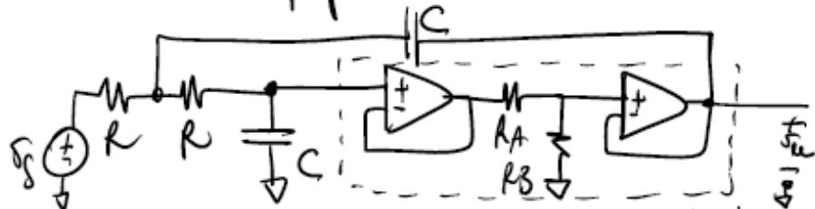
$$R_B = 9.35 \text{ k}\Omega \quad || \text{ il blocco nel riguardo} \\ R_A = 650 \text{ }\Omega \quad || \text{ tratteggiato amplifica } \underline{\underline{0.935}}$$
