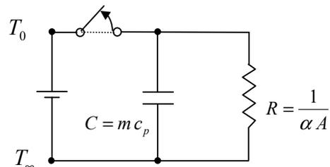
La refrigerazione del corpo segue lo stesso andamento della scarica del condensatore del circuito elettrico equivalente che avviene a partire dall'istante di apertura dell'interruttore.
