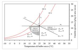
N.B.: Se il fattore termico è, ad esempio, 0.8 si ha che il carico è costituito dall'80 % di calore sensibile e dal 20 % di calore latente. Quando il valore del fattore termico R è 1 la retta di lavoro è orizzontale, cioè il carico termico è dato dal solo calore sensibile. Se  $R=\infty$  ( $Q_{sens}=-Q_{lat}$ ) la trasformazione diventa una isoentalpica (saturazione adiabatica). Quando R=0 il carico termico è costituito dal solo carico latente e la retta di lavoro è quindi verticale.
