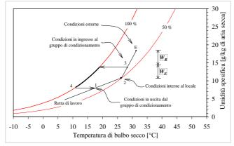
In alcuni casi è possibile evitare il post-riscaldamento (4-1) sfruttando il bypass dell'aria di ricircolo.
