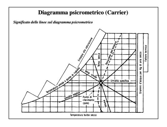
Il benessere umano dipende principalmente da tre fattori: la temperatura di bulbo secco (20÷26 °C), l'umidità relativa (40÷60 %) e la ventilazione (0.05÷0.3 m/s).
