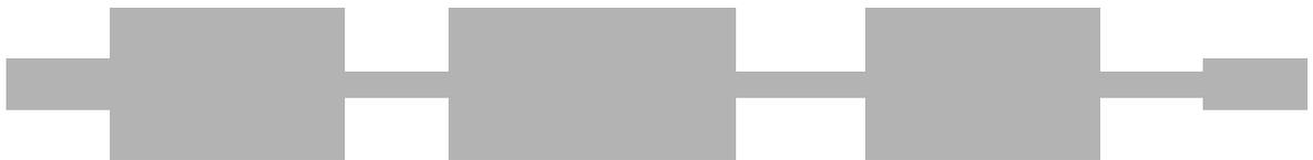
**Figura 11.25:** Layout del Filtro del sesto ordine realizzato con linee di trasmissione ad alta e bassa impedenza caratteristica. (Le dimensioni dei tratti di linea non sono in scala).
