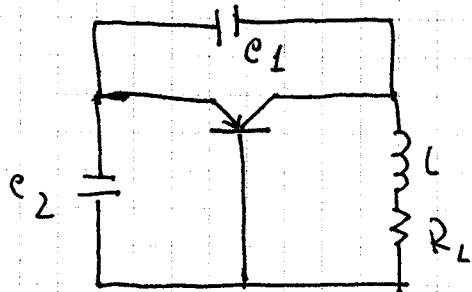
Se si opera una trasformazione serie-parallelo del gruppo  $R_L - L$  si ottiene la configurazione tipica di un oscillatore di Colpitts.
