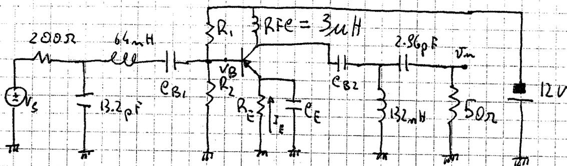
$R_1, R_2, R_E$  devono essere scelti in modo da ottenere  $V_{CE} = -10$   $I_C \approx I_E = 2 \text{ mA}$
