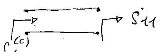
SIAMO LA LINEA È A SONO SI PUÒ PASSARE DA  $S_{11}$  (CHE COSTITUISCE UN CARICO PER LA LINEA) A  $S_{11}^{(c)}$  NOTANDO SULLE C.D.S. IL VERSO ORARIO DI 0.2A SI TROVA:  $S_{11}^{(c)} = 0.61 \angle 35^\circ$
