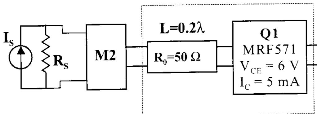
Nello schema in figura la corrente  $I_S$  è sinusoidale con frequenza 1 GHz e ampiezza 0.2 mA (valore di picco). La resistenza  $R_S$  è pari a 200  $\Omega$ .
