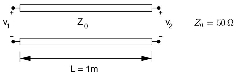
Calcolare i parametri  $Y$  del quadripolo in figura (la linea di trasmissione si intende in aria).
