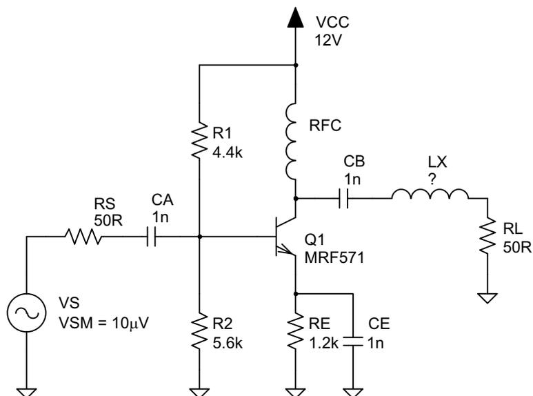
1. Dato l'amplificatore in figura, con frequenza di lavoro  $f = 1\text{GHz}$ , calcolare il valore dell'induttanza  $L_x$  che massimizza il guadagno di trasduttore, ed il valore del guadagno stesso.
