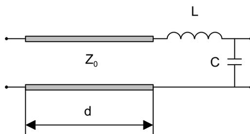
Calcolare i parametri  $y_i$  ed  $y_f$  del doppio bipolo dato in figura, sapendo che la linea di trasmissione è in aria, e che  $Z_0 = 100\ \Omega$ ,  $L = 10\ \text{nH}$ ,  $C = 100\ \text{pF}$ ,  $d = 10\ \text{cm}$ ,  $f = 750\ \text{MHz}$ .
