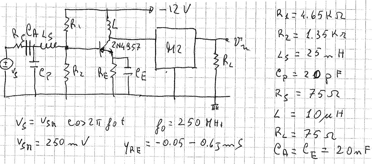
B) Calcolare, se esiste, il valore di  $C_E$  per cui il circuito in figura si comporta come un oscillatore con frequenza di innesco pari a 80 MHz.
