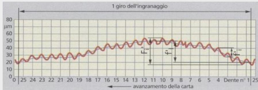
⇒ Tip relief, root relief, lead crowning e profile crowning possono essere usati efficacemente per minimizzare l'errore di trasmissione.
